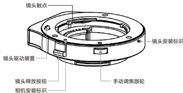
**卡口适配器TA-GE1系列**是一种用于配备有E卡口系统的SONY可更换镜头数码相机（以下简称“相机”）的适配器。在E卡口系统上安装Contax-G系列镜头（以下简称“镜头”）时，请使用此卡口适配器。
